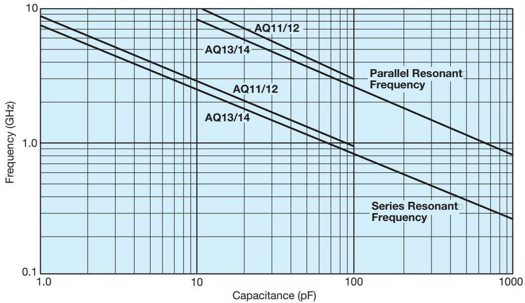
TYPICAL RESONANT FREQUENCY vs. CAPACITANCE
